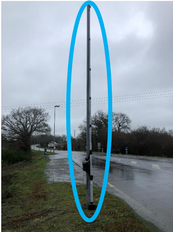
Exemple de mât de comptage à proximité du giratoire de la RD537
